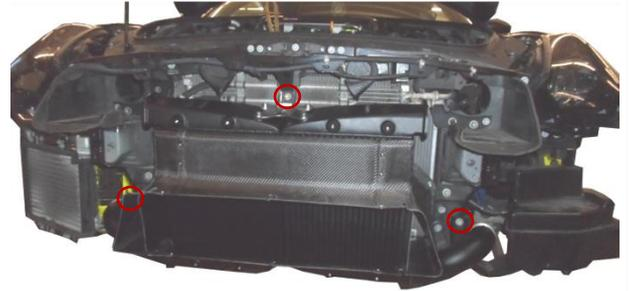
Dichtringe einsetzen und die oberen Aluminium-Verrohrungen montieren. Dafür werden die mitgelieferten 6Stk. Innensechskantschraube M6x16, 2Stk. Gewindestift M6x25 und 2Stk. Sechskantmutter M6 benötigt. Auch hier empfiehlt es sich zusätzlich mit einer flüssigen Schraubensicherung zu arbeiten.
