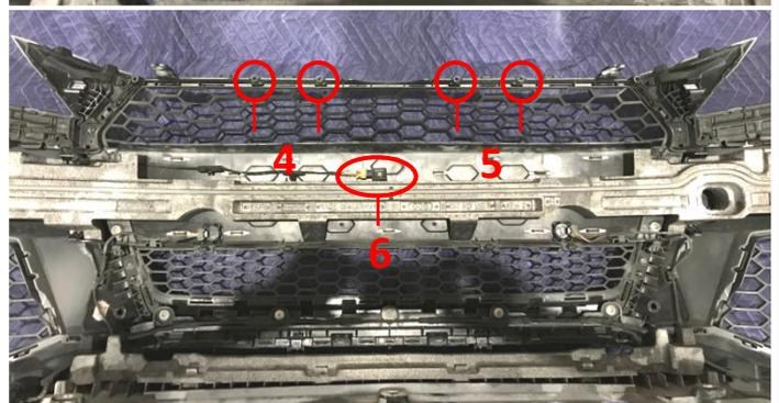
Prüfen Sie alles auf korrekten und festen Sitz. Scheinwerfer, Stoßfänger, Kunststoffabdeckung, Radhausschalen sowie Unterboden wieder am Fahrzeug verbauen.
